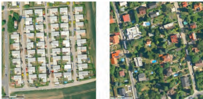
Obr. Srovnání hustoty zástavby. Vlevo část obce Chýně, velmi hustá zástavba, koeficient zastavěné plochy KZP= cca 0,7 (tzn. cca 70%). Vpravo mapa ve stejném měřítku, část obce Černošice. Hustota zástavby je řádově nižší.
